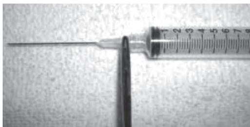
**Fig. 1.7.** Errato punto di clampaggio: porzione plastica dell'impugnatura.
